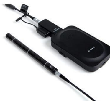
Unità base del Mako con inserito il modulo per camera a ionizzazione, e attaccata la camera a ionizzazione per CT.
