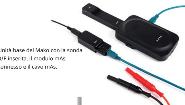
Unità base del Mako con la sonda R/F inserita, il modulo mAs connesso e il cavo mAs.
