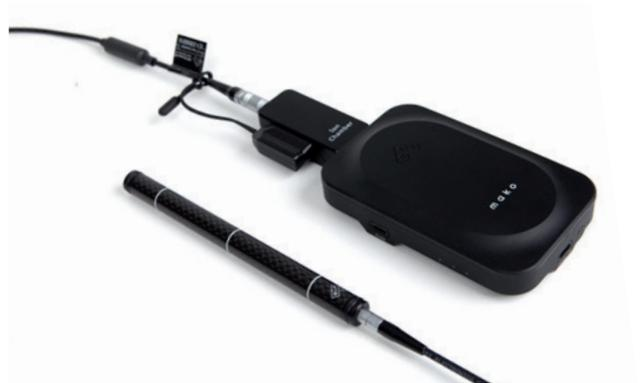
Unità base del Mako con inserito il modulo per camera a ionizzazione, e attaccata la camera a ionizzazione per CT.
